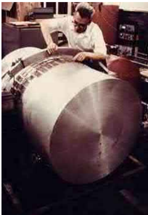
Weberjev aparat za zaznavo gravitacijskih valov
